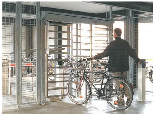
**Bild 45:** Fahrradkleingarage mit Zulassungsbeschränkung [22]
