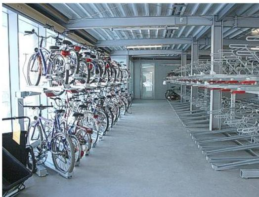
**Bild 44:** Doppelstockparker in einer Fahrradabstellstation [22]
