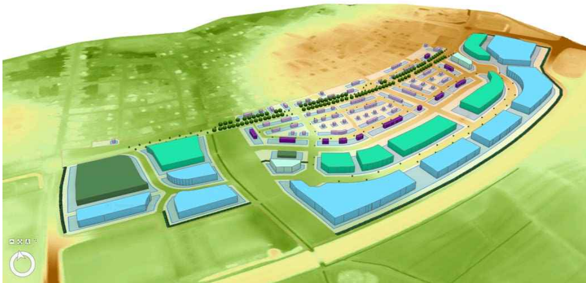
Abbildung 10 Planfall des Bebauungsplans Nr. 85 "Dieburg Süd" 3D modelliert mit geplanter Bebauung (blau und grün rd. 14 m Gebäudehöhe, dunkles lila 3 Vollgeschosse (9 m), helles lila 2 Vollgeschosse (6 m)) sowie mit Besatz von Bäumen (entsprechend B-Plan)
